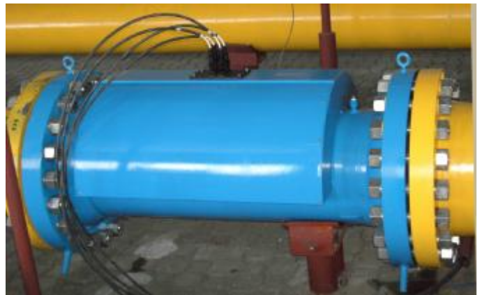
Рисунок 4 – Внешний вид КИУ с ПЭА (ПЭА закрыты защитным кожухом)
